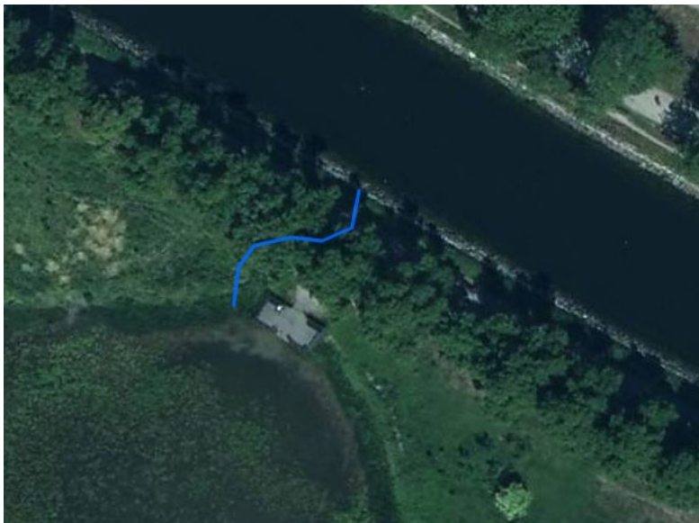
Figur 15. Placering av cirka 25 m lång fiskpassage mellan Djurgårdsbrunnskanalen och Isbladskärret.
